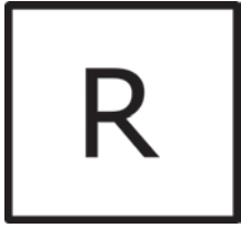
Figura 27. Símbolo de equipo reparado que cumple con la UNE EN 60079-19: 2011 y el certificado y/o especificaciones del fabricante.
