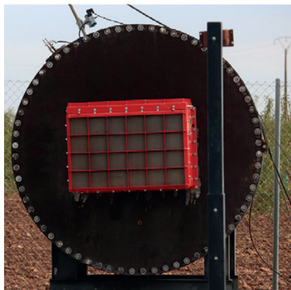
Figura 22. Dispositivo de descarga de la presión de explosión: panel de venteo sin llama.
